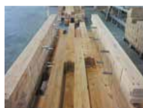
協定工場で構造用集成材に高耐久金物を取り付け加工。
