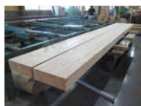
搬入された製材を柱や梁に使用する集成材に加工。
