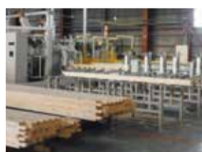
搬入された製材を構造用のプレート部材に加工。
